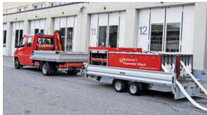
Die beiden Schlauchcontainer mit jeweils 400 m A-Druckschlauch können auch per Hubschrauber transportiert werden.
