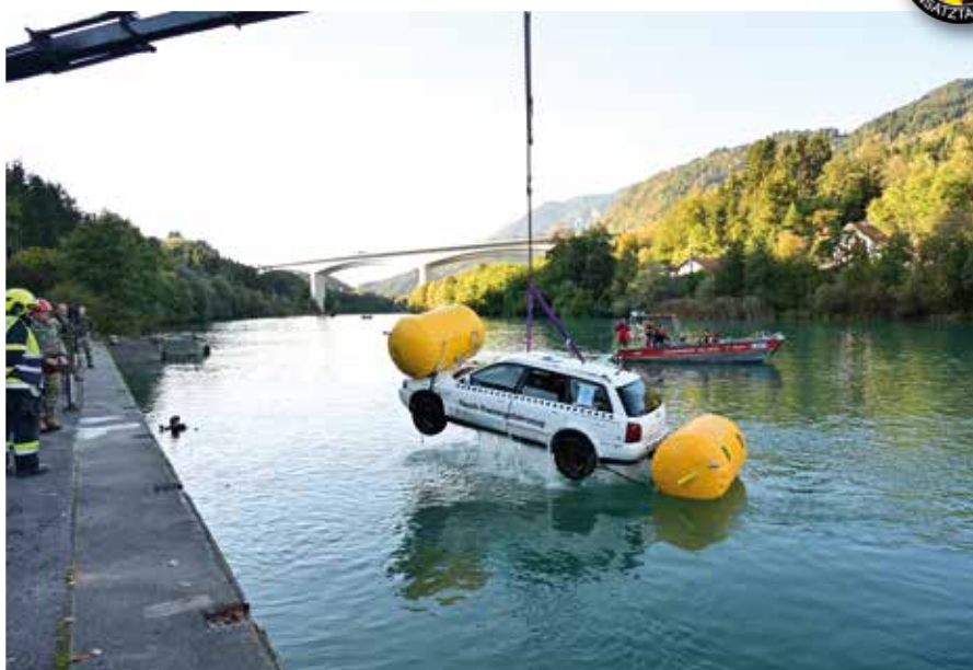
Nachdem die Taucher mit den Hebeballonen das Fahrzeug an die Oberfläche der Drau brachten, erfolgte die Bergung durch die Landmannschaft mit dem Rüstkran.
