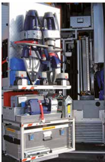
Der erste eDraulic-Satz in Kärnten im Geräteraum 2 des RTLF-A-6500-Tunnel.
