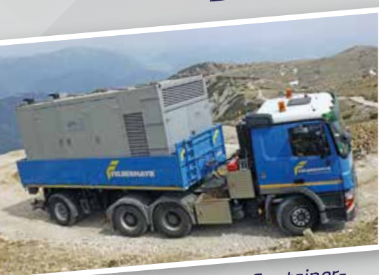
Transport 1100 kVA-Container- aggregat zum Sender Dobratsch
